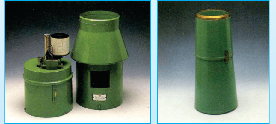
स्वतः वर्षामापी एवं साधारण वर्षामापी Self recording raingauge and Ordinary raingauge
