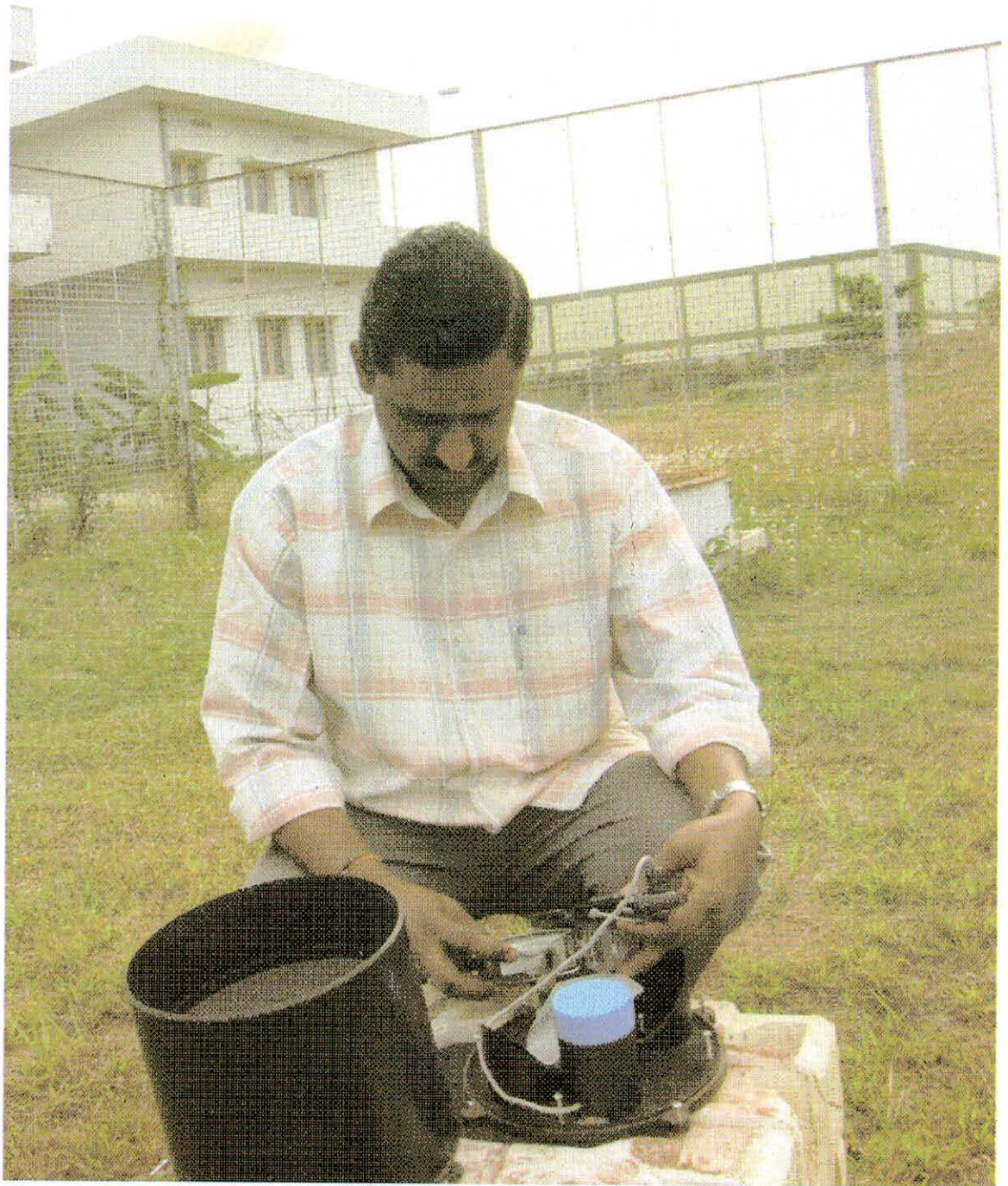
3.9 काकीनाड़ा शहर के शहरी जलविज्ञान अध्ययन के अन्तर्गत डाटा शटल तथा अंकीय वर्षा मापी के प्रयोग से वर्षा आंकड़ों का हस्तान्तरण ।
