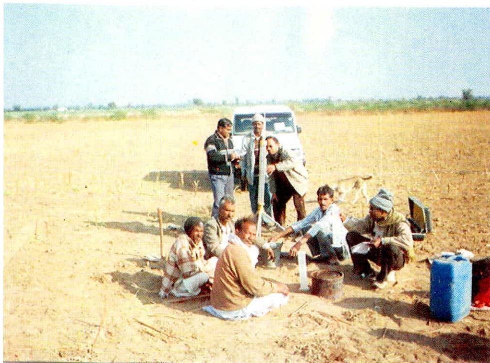
चित्र 60:- जसवन्त सागर बाँध, जोधपुर के जलसंचयन क्षेत्र में गुल्फ मीटर द्वारा संस्था ने जल चालकता के मापन हेतु क्षेत्रीय प्रेक्षण।
