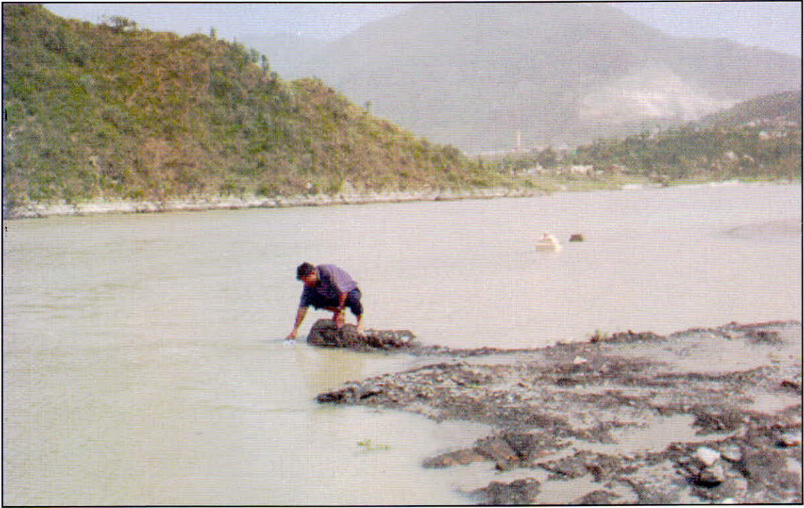
3.5 समस्थानिक विश्लेषण के लिए टिहरी ( उत्तराखण्ड ) में भागीरथी नदी से जल नमूनों का एकत्रीकरण ।
