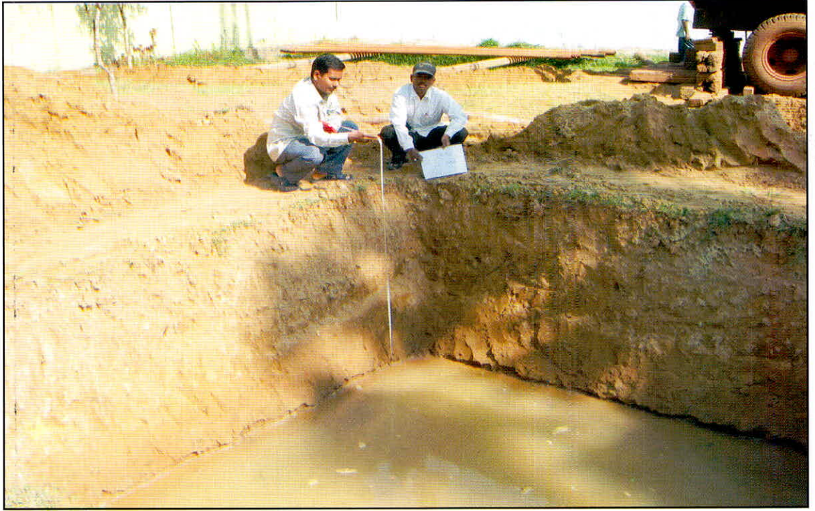
3.3 भूजल स्तर के साथ उप सतही प्रोफाइल का अध्ययन क्षेत्र ( काकीनाडा ) में नाइट्रेट संदूषण ।
