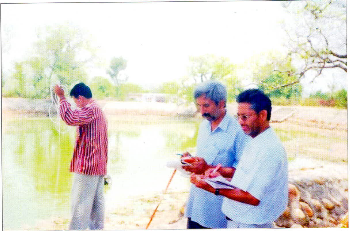
कांडी बेल्ट (जम्मू) में एक ताल के निकट डबल रिंग अन्तः स्यन्दनमापी के प्रयोग से मृदा अन्तःस्यन्दन परीक्षण का कार्य प्रगति पर।
