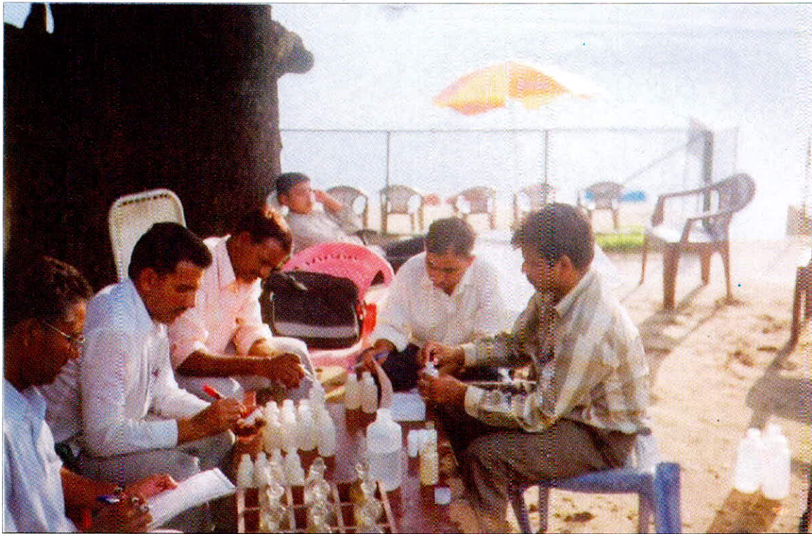
उधमपुर (जम्मू एवं कश्मीर) जनपद की मानसर झील में जल के नमूनों के परिरक्षण तथा जल गुणता अनुवीक्षण का कार्य चलता हुआ।
