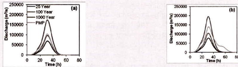
चित्र 2 : (क) 1-दिवसीय वर्षा और (ख) 2-दिवसीय वर्षा के कारण बारगी बांध का जलप्रवाह।
