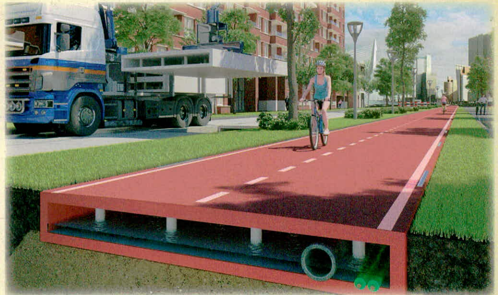
पन्नीयों को चक्रित कर सड़क निर्माण के उपयोग में लाया जा रहा है
