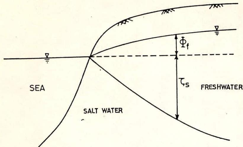
FIG. 2 : THE GHYBEN-HERZBERG INTERFACE MODEL
