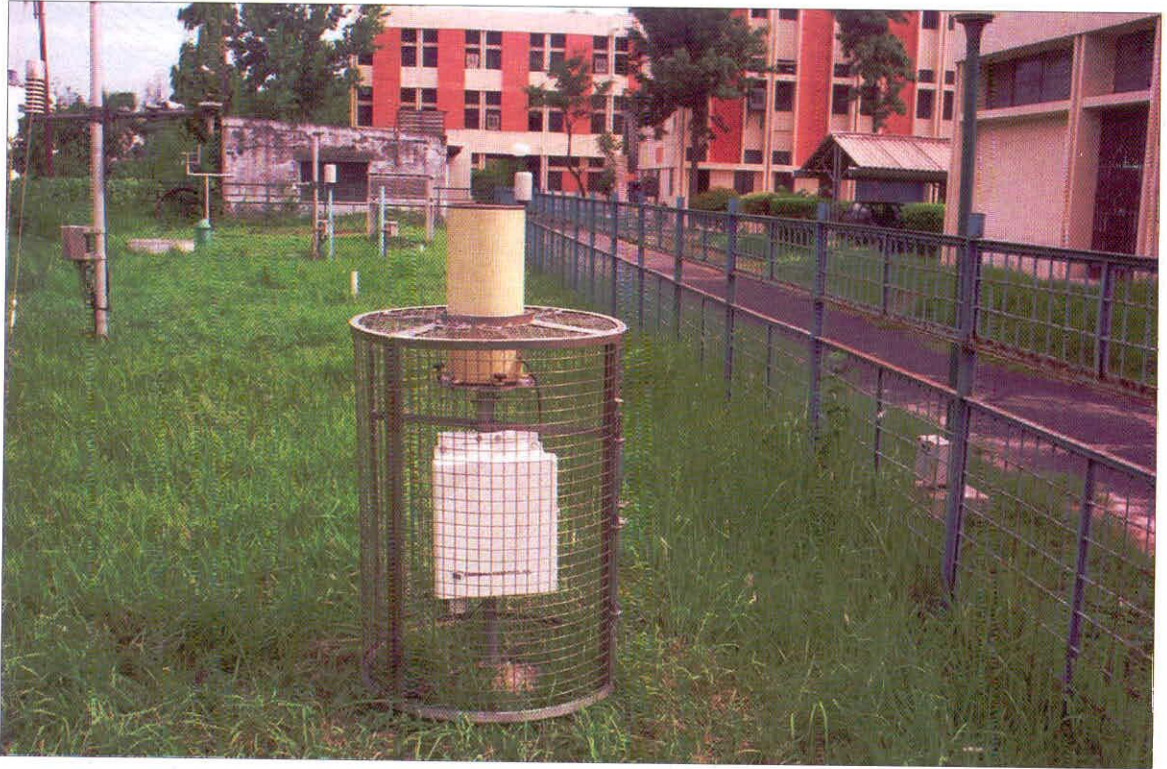
संस्थान परिसर, रुड़की में परीक्षण के दौरान तौल वर्षामापी
