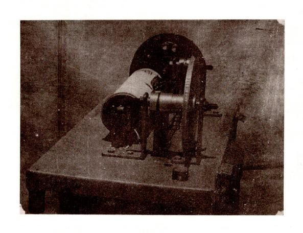
PLATE 1 : BELLARY TYPE WATER LEVEL RECORDER
